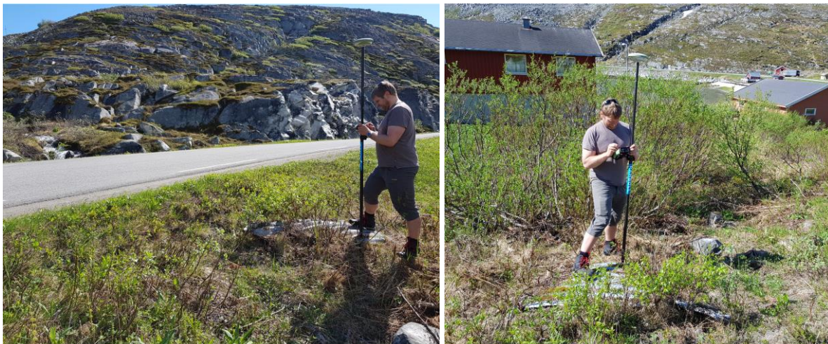
Bilde 5-1. Registrering av topp kulvert svalbardrør nedstrøms kulvert innløp, etter kryssing av fv. 8070.
