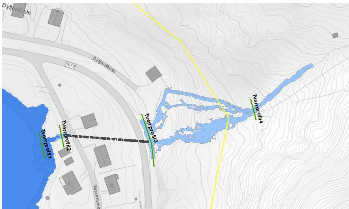
Figur 5-6. Oversikt over tverrprofiler langs bekkefaret for å sammenligne vannstand ved Q200kl (ny situasjon) og Q200kl med sensitivitetsanalyse. Plangrense er gul stiplede linje.
