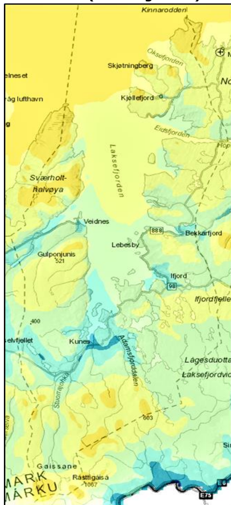
Figur 1 Vindressurskart for gjennomsnittlig vindstyrke 50 m over bakkenivå. Tallene indikerer meter per sekund. Kilde: NVE
