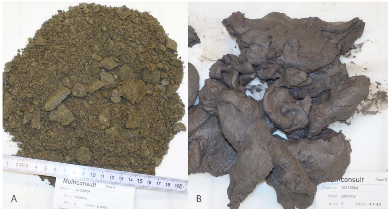
Figur 4-2: A) Sandig grusig materiale fra BP.1 dybde 0,4-0,9 m. B) Leire fra BP.5 dybde 4,4-4,9 m
