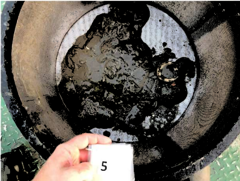
Figur 9-5: Bilde av sedimentet ved C5. Sedimentet besto av sand og stein. Foto: Aqua Kompetanse AS.
