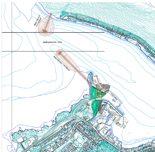
Figur 6 – Skisse fra Kystverket over mulig løsning på nye moloer i innseilingen til Kjøllefjord.
